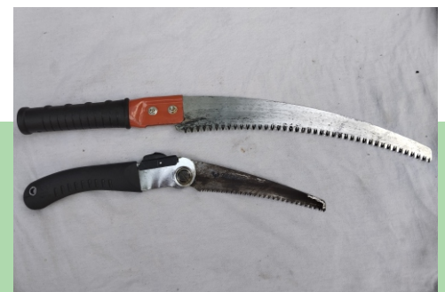
Figura 40: Serrote japonês: equipamento para galhos mais grossos, podendo ser de diferentes tamanhos e acoplados a cabos extensores.
