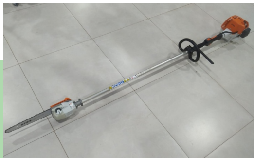
Figura 41: Moto-podas com cabo extensor facilita o acesso a galhos altos e grossos.
