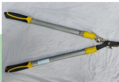
Figura 39: Tesoura de poda com cabo longo: facilita o acesso a galhos mais altos e grossos.
