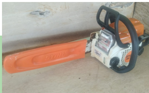
Figura 42: Motoserra: similar a moto-poda, mas deve ser usado para cortar na altura da cintura até o joelho. Precisa de licença de porte e uso.
